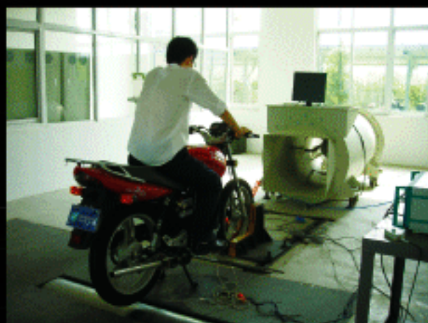
● 觸媒檢測設備-摩托車性能底盤 測功能機 Chassis Dynamometer
